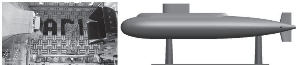
图5 开口声学风洞与试验模型
