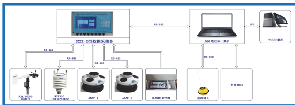
图 1 环境测量系统构架
