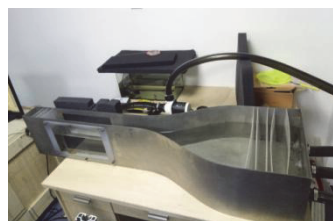
图 5 小型循环水槽示意图
