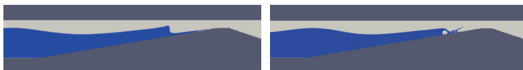
图 2 波浪在海堤上的爬坡和破碎
