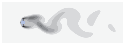
图 8 湍动能分布云图 ( Re=370 )
