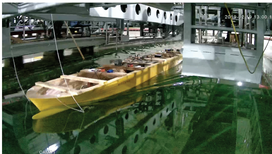
图5 自由自航波浪增阻试验照片（船首视角）
