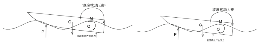
图 25 阻流板位置影响航行姿态的原理
