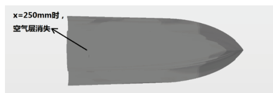
图 22 x 较大时空气层消失
