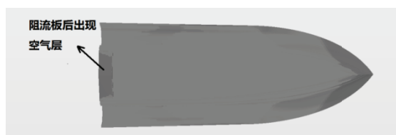
图 21 阻流板后出现空气层
