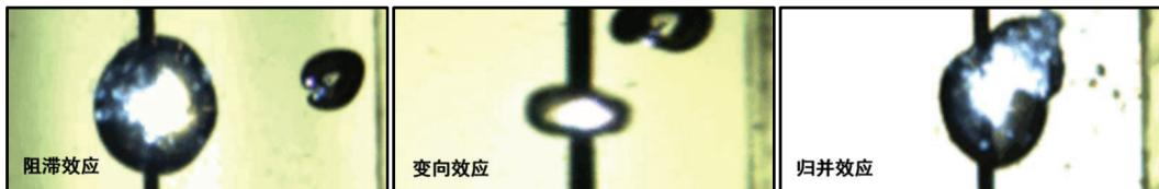
图 6 空气泡对空化泡的阻滞—变向—归并作用
